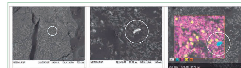
Figura 2 – Dados de uma contaminação física identificada dentro de um queijo Caprino condimentado: morfologia por microscopia eletrônica de varredura (MEV) e microanálise por espectroscopia por dispersão de energia (EDS), caracterizando a contaminação como alumínio metálico.
